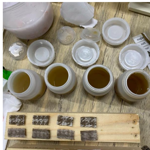
膠の濃度変化による塗りの実験
